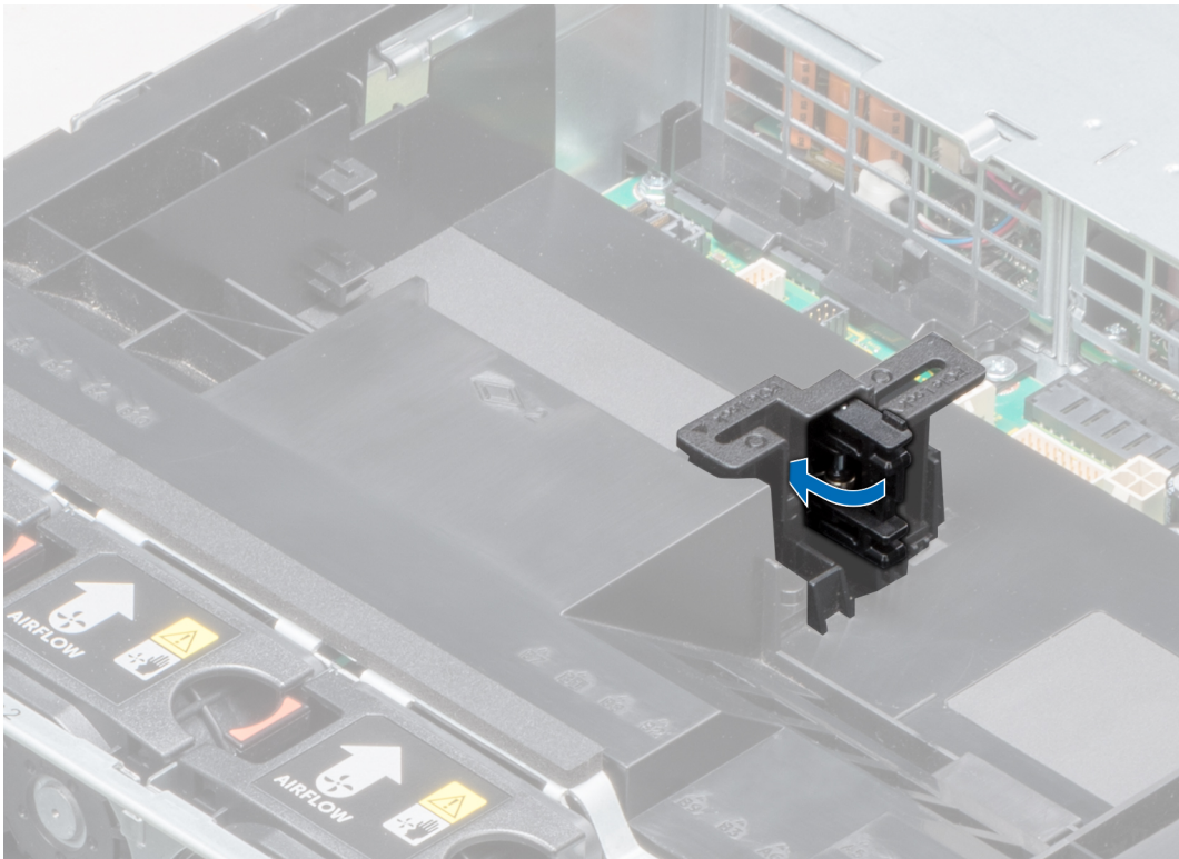
그림 49. PCIe 카드 홀더 래치 닫기
