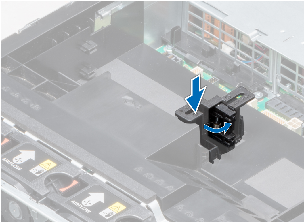
그림 48. PCIe 카드 홀더 래치 열기
